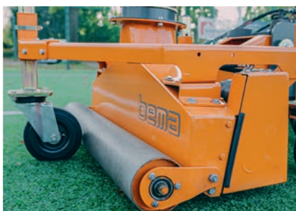
Störungsfreier Einzug durch die pendelnde Niederhalterwalze
